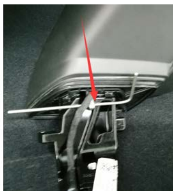
2.7、拆下灯条 (2 颗螺钉,3 个卡扣)
