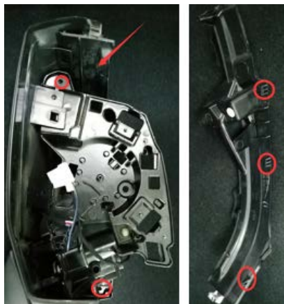
2.7、拆下灯条 (2 颗螺钉,3 个卡扣)
