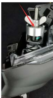
2.7、拆下灯条 (2 颗螺钉,3 个卡扣)
